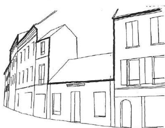
Rupture de la ligne des égouts par une construction trop basse.
